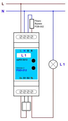
La description des bornes à vis est imprimée sur l'étiquette de l'adaptateur. Le symbole sinusoïde avec une flèche désigne l'entrée du gradateur, les lettres « B » désignent l'emplacement du branchement du module optionnel Fibaro Bypass FGB-002.
