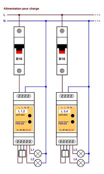
La description des bornes à vis est imprimée sur l'étiquette de l'adaptateur. Les lettres « Q1 » et « Q2 » désignent les sorties des relais.
