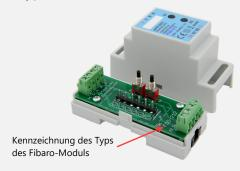
3. Fibaro-Modul vorsichtig auf die Anschlussleiste bis zum Widerstand aufsetzen und <u>alle</u> Schrauben im Modul festziehen
