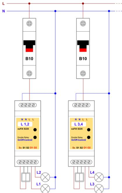
Die Beschreibungen der Schraubklemmen werden auf dem Etikett des Adapters angegeben. Die Buchstaben „O1“ und „O2“ kennzeichnen die Ausgänge der Relais.
