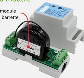
4. Fermez le boîtier, montez l'adaptateur sur le rail DIN, connectez les fils et laissez une description module
