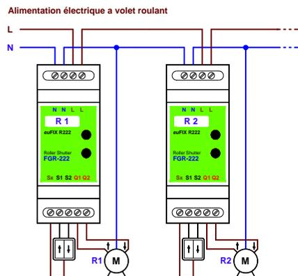
La description des bornes à vis est imprimée sur l'étiquette de l'adaptateur. Les lettres « Q1 » et « Q2 » désignent les sorties des relais.
