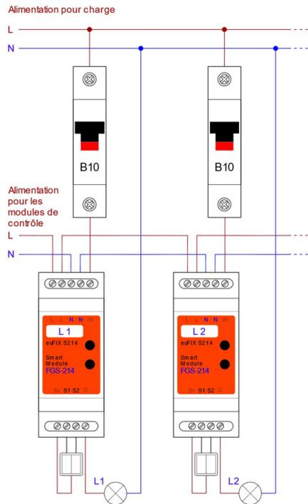
La description des bornes à vis est imprimée sur l'étiquette de l'adaptateur. La description « IN » signifie l'entrée d'alimentation du dispositif de réception, et la lettre « Q » désigne la sortie du relais.
