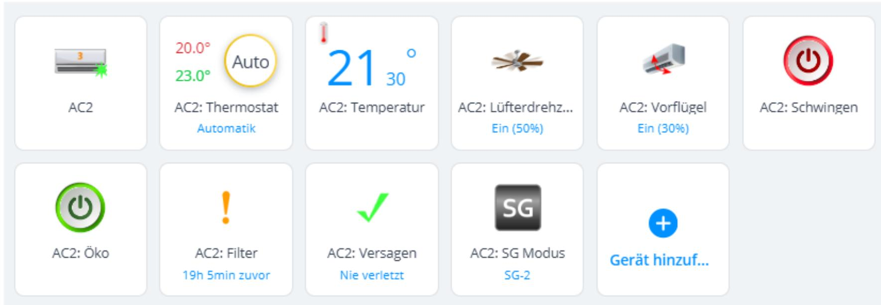
Diese gesamte Gruppe oben stellt eigentlich nur ein Gerät dar, nämlich die Klimaanlage, die im vorliegenden Beispiel AC2 genannt wird. Es ist das erste in der obigen Liste und ist das übergeordnete Gerät (*Elternteil*). Die anderen Geräte stellen verschiedene, aber sehr elementare Funktionen dieses einen Klimagerätes dar. Alle diese Geräte werden in der folgenden Tabelle zusammen mit Beispielen für ihre Verwendung in Szenen beschrieben.
