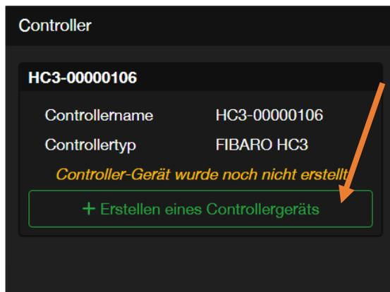
Wenn Sie im MODBUS-Gerätekonfigurationsfenster nach unten blättern, wird der Abschnitt "Controller" mit der grünen Schaltfläche "Erstellen eines Controllergeräts" angezeigt.
